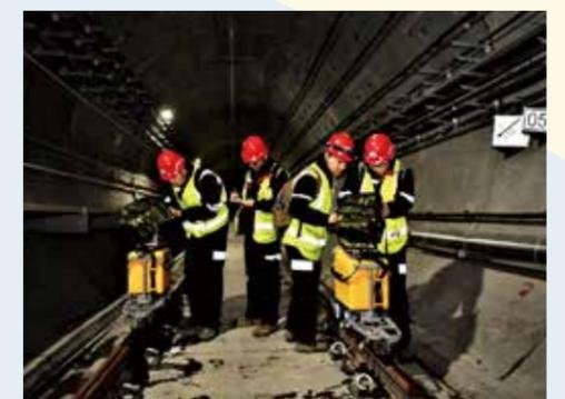
利用钢轨探伤仪在地铁线路进行钢轨探伤
